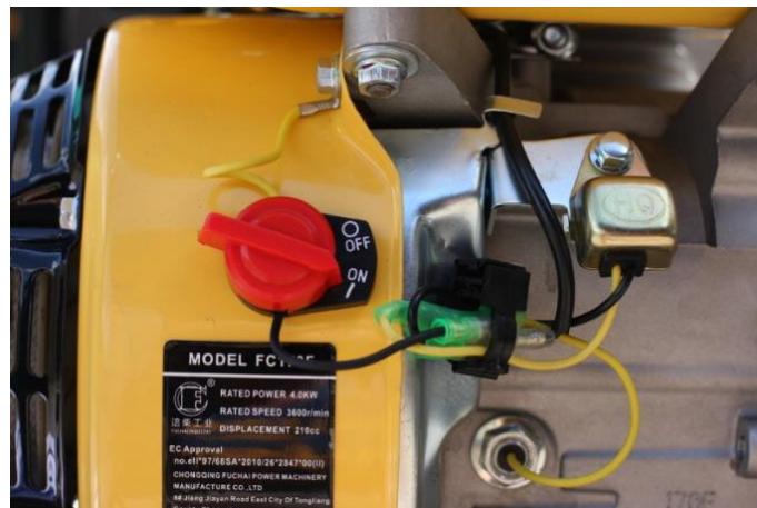
Huvudströmbrytare och bränslekran (överst); choke-reglage och varvtalsreglage (nederst).
